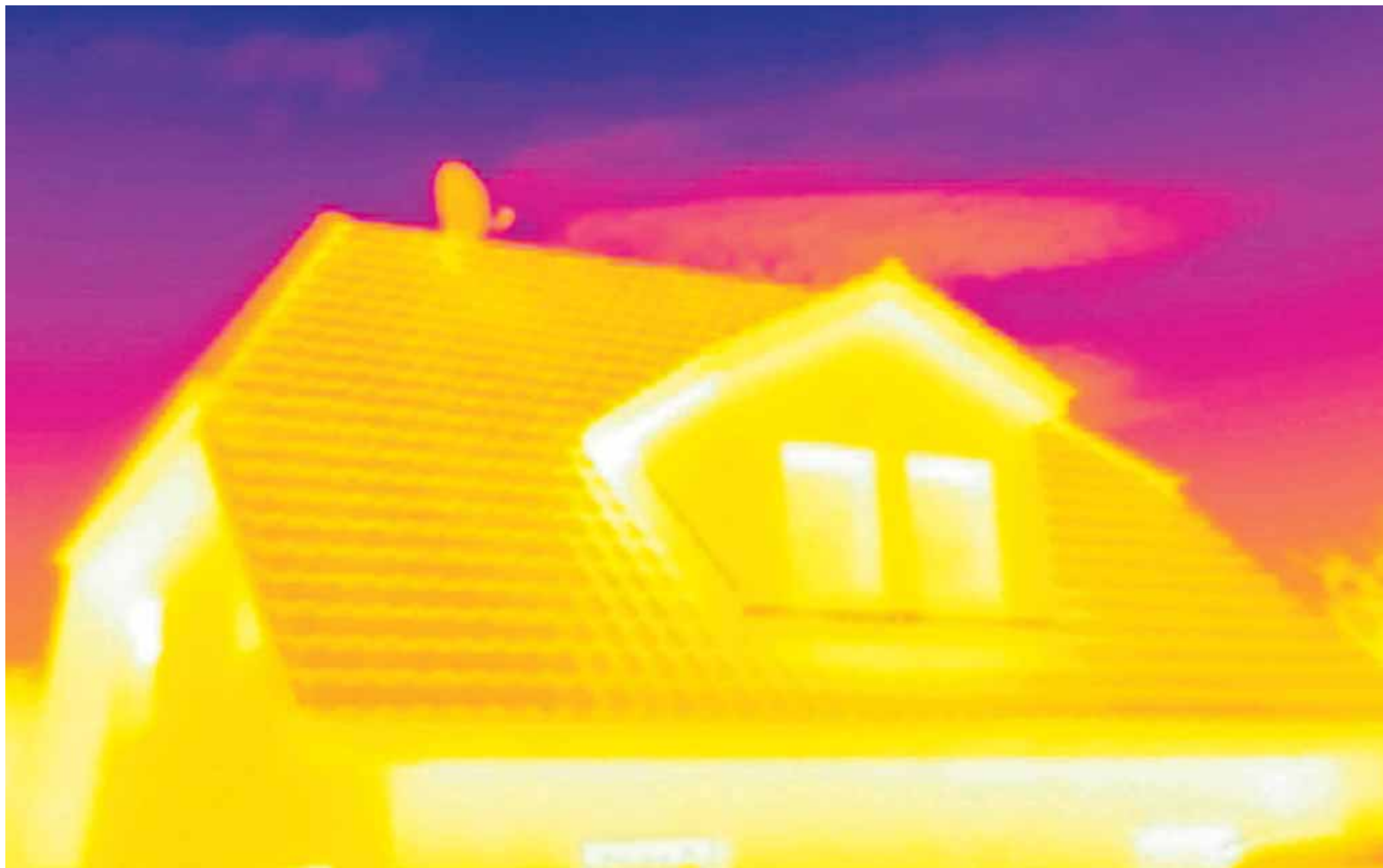
Mit einer Wärmebildkamera lassen sich energetische Schwachstellen finden, an denen nachgebessert werden kann.
