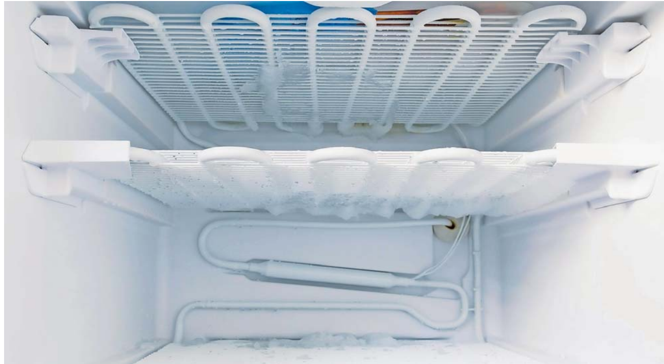
Das Kühlmittel aus Gefrierschränken und Klimaanlage entweicht mit der Zeit und muss ersetzt werden.
