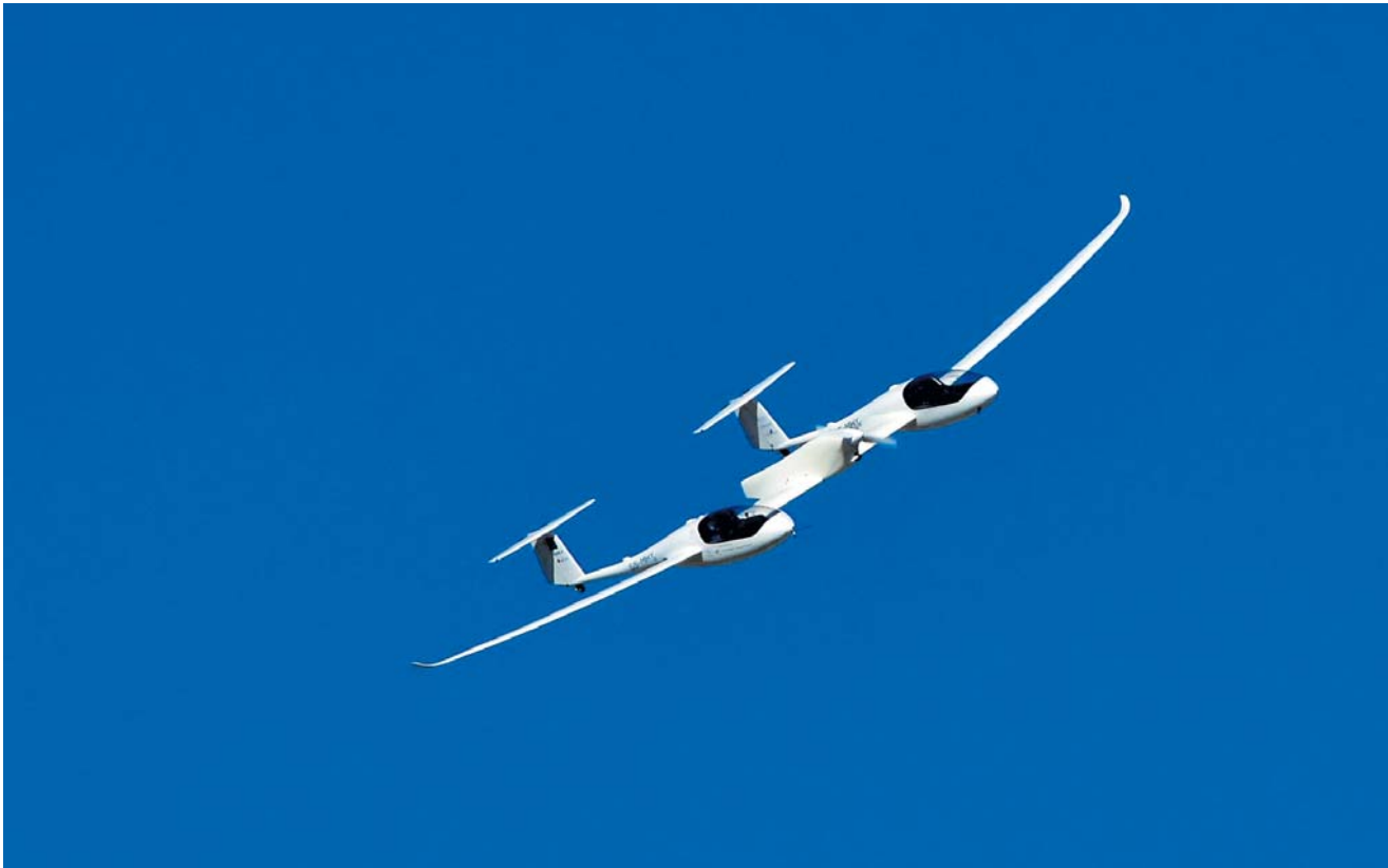
Die HY4 ist das erste Passagierflugzeug, das mit einem Wasserstoffbrennstoffzellen-Batterie-System fliegt. Bislang haben jedoch nur vier Personen Platz.
